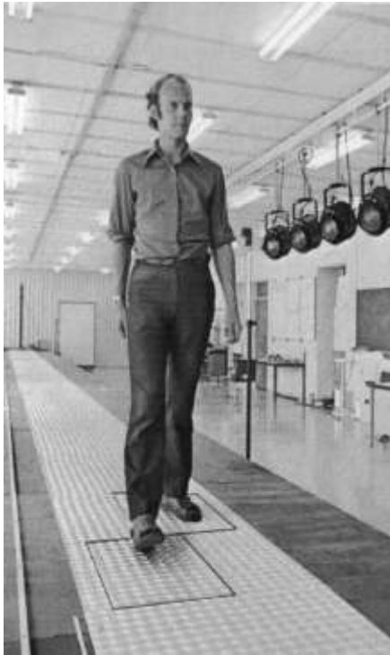
Platforma dynamometryczna do badania chodu.
